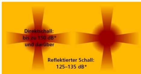
Abbildung 12: Vergleich zwischen Standarddüsen und Silent Nozzle unter Berücksichtigung von Direktschall und reflektiertem Schall
